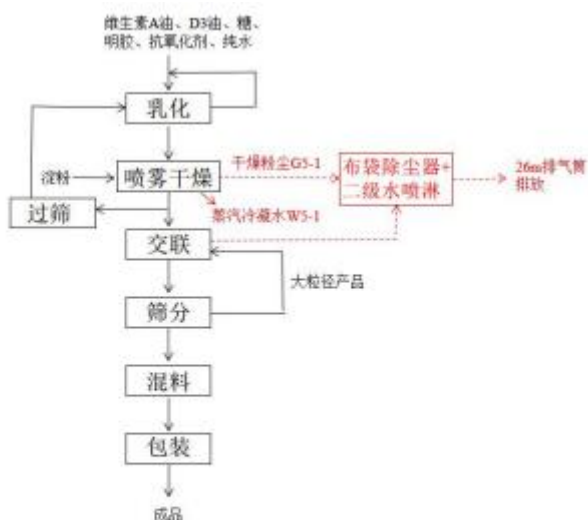
图 2-7 维生素 AD3 微粒生产工艺流程及产排污环节图
