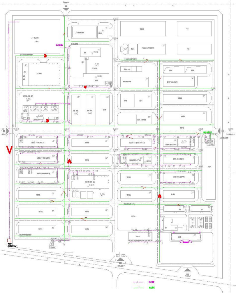
新厂区雨污管线图
